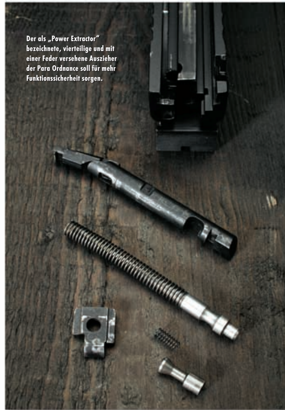
Abzugsstange des Light Double Action (LDA)-Systems der kanadischen Para Ordnance-Pistole. Das Innenleben der Mechanik ist äußerst kompliziert aufgebaut.
