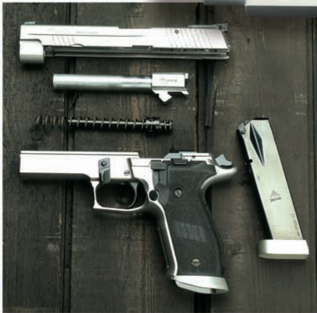
Demontierte X-Five Double Action mit zweiteiligem Schließfedersystem mit Rückstoßdämpfer.
